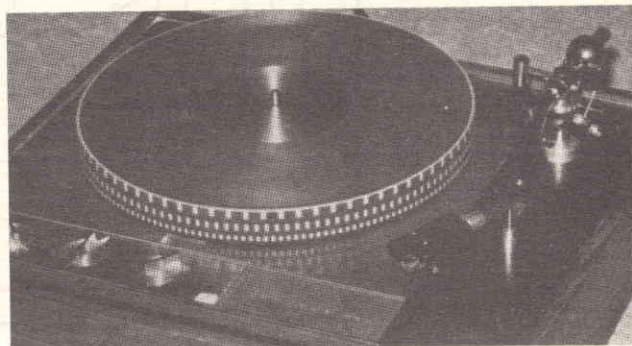
Fig. 7 - I tre sistemi stroboscopici applicati lungo il bordo del piatto di questo giradischi sono riferiti alle tre velocità di rotazione consentite dal dispositivo.
