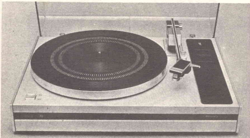
Fig. 4 - Esempio di applicazione di due corone circolari stroboscopiche sulla superficie di appoggio del piatto rotante di un giradischi.
