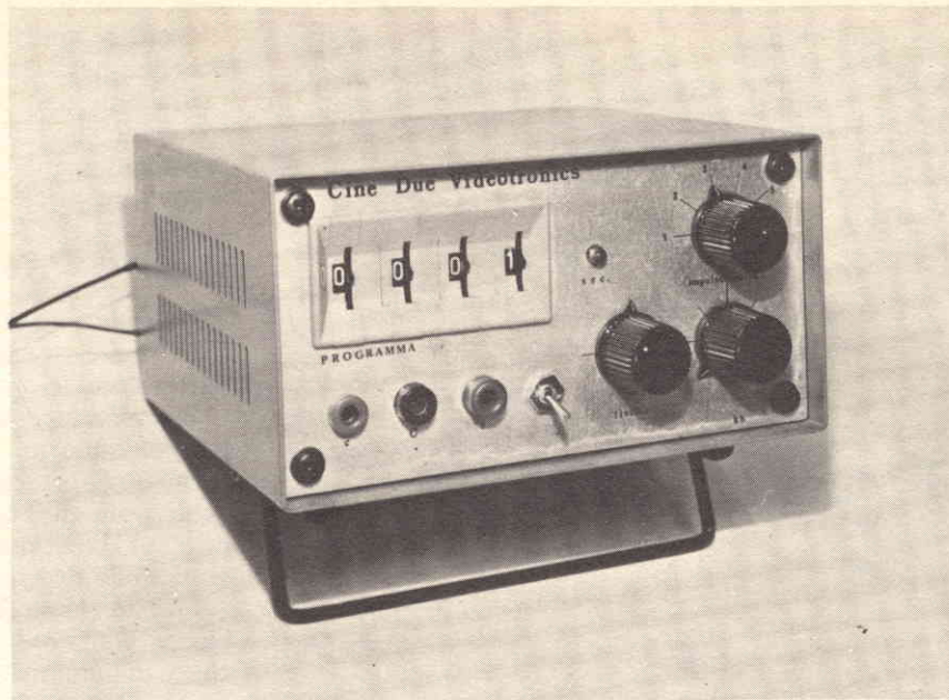
Fig. 1 - Prototipo del temporizzatore ciclico professionale, descritto in questo articolo.
